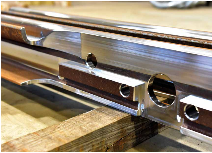
Links: Mehrere Kanten, Radien und Bohrungen auf engem Raum lassen erahnen, wie aufwändig die Produktion einer Weiche ist. Rechts: Wer genau hinschaut, erfährt auch in anderen Städten, dass diese Weiche aus Leipziger Fertigung stammt.
