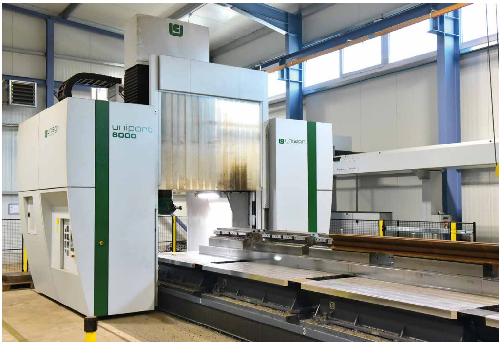
Die neue Portalfräsmaschine bei IFTEC ist mit einem verfahrbaren Bearbeitungszentrum (links) für bis zu zehn Meter lange Werkstücke ausgestattet.
